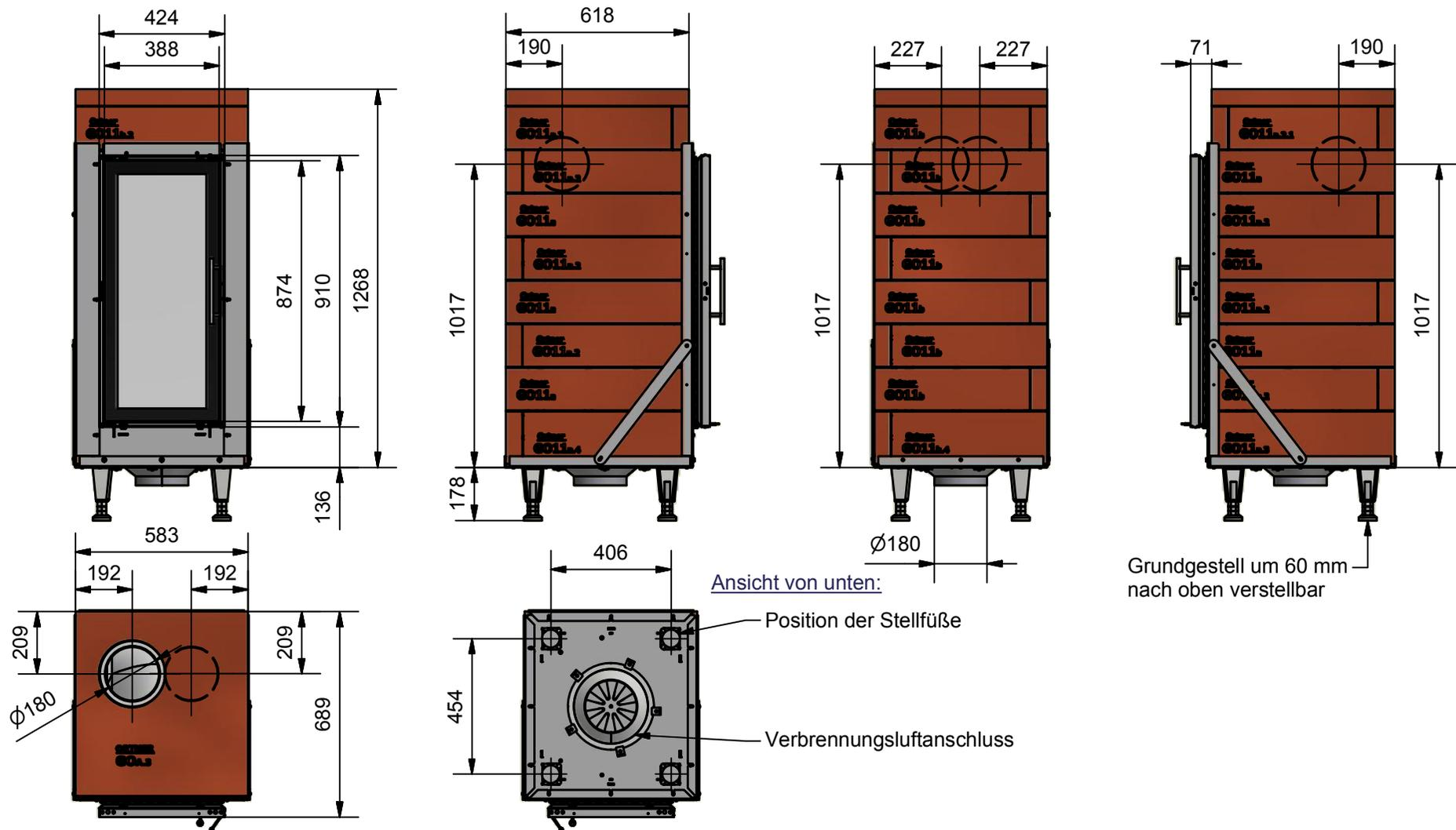
Alle Höhenangaben gelten bei einer Mörtelfugenstärke von 3 mm, einer Fasermattenstärke von 3 mm (im zusammengepressten Zustand) und vollständig nach unten geschraubtem Grundgestell.
